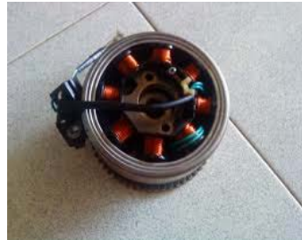
Gambar 2.9 Bagian dalam Dinamo Motor
