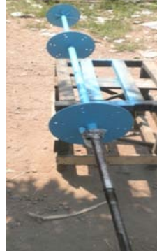
Gambar 3.3.2 Poros dengan Penyangga Lengan
