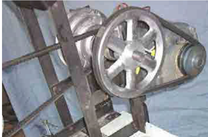
Belt drive pada mesin bubut
