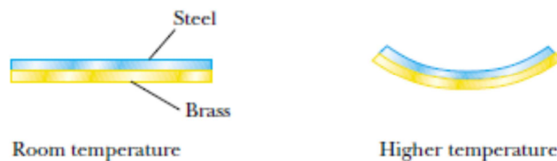
Gambar 6.7. Keping bimetal ( kiri ) dan keping bimetal yang telah memuai ( kanan )
