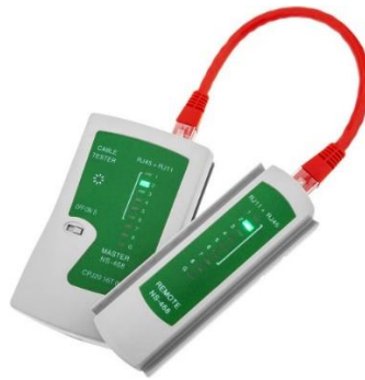
Gambar 4. Melakukan pengetesan kabel LAN
