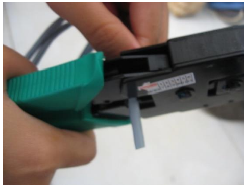
Gambar 1. Memotong kabel LAN
