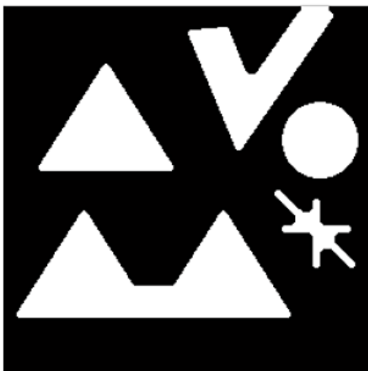
(d) Operasi closing dengan strel('disk', 5)
