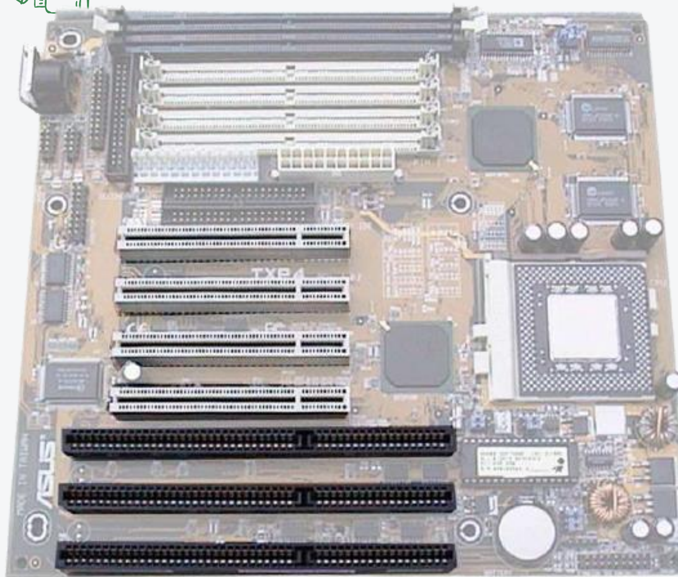
Gambar 3.18 Letak port ISA dan PCI dalam motherboard
