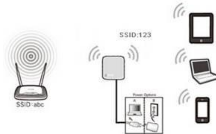
Gambar 11.9 Pengaturan Access Point sebagai AP Client Router
