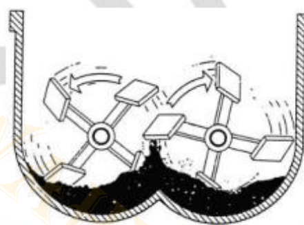
b. Campuran terlalu sedikit (underfilled)
