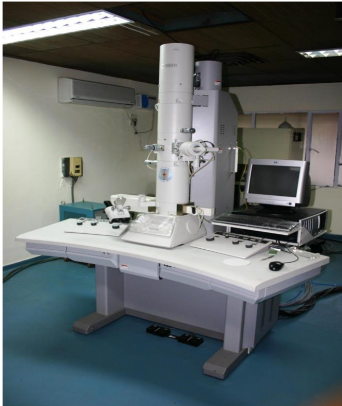
Gambar 4. Mikroskop elektron adalah sebuah mikroskop yang mampu untuk melakukan pembesaran objek sampai 2 juta kali, yang menggunakan elektro statik dan elektro magnetik untuk mengontrol pencahayaan dan tampilan gambar serta memiliki kemampuan pembesaran objek serta resolusi yang jauh lebih bagus daripada mikroskop cahaya
