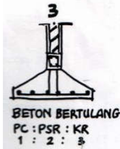
KONSTRUKSI PONDASI FOOT PLAT
