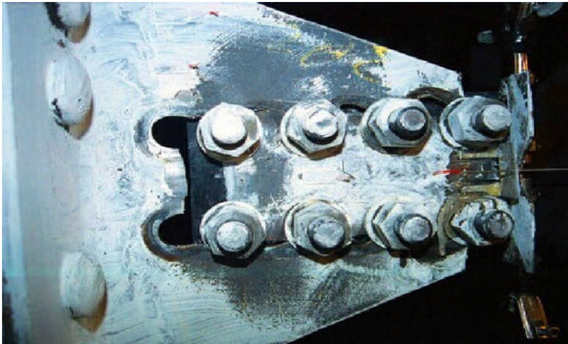
Gambar 15 : Keruntuhan geser blok, penampang tarik netto.
