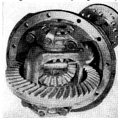
Gambar 9. Roda Gigi Diferensial Kerucut Hipoid
