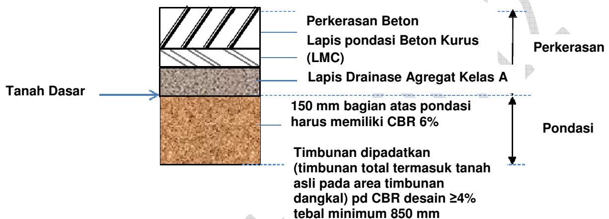
Struktur Perkerasan Kaku Pada Timbunan
