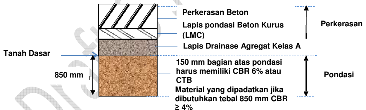
Struktur Perkerasan Kaku Pada Galian
