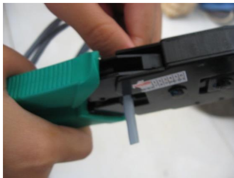
Gambar 1. Memotong kabel LAN
