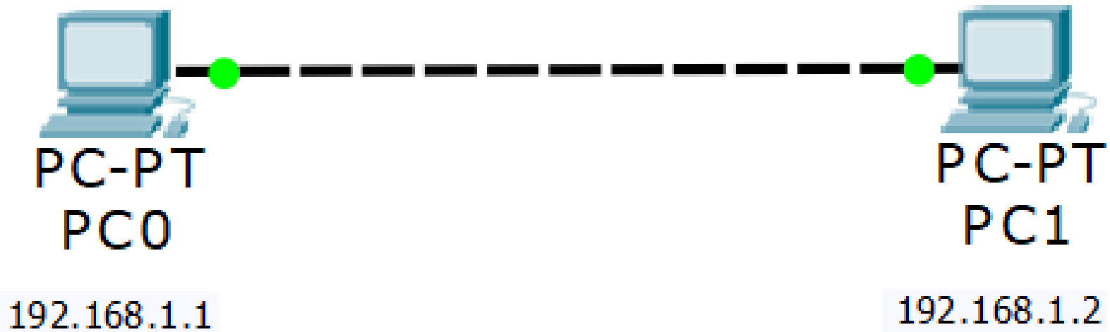
Gambar 11.4 Jaringan komputer 2 PC dengan kabel crossover
