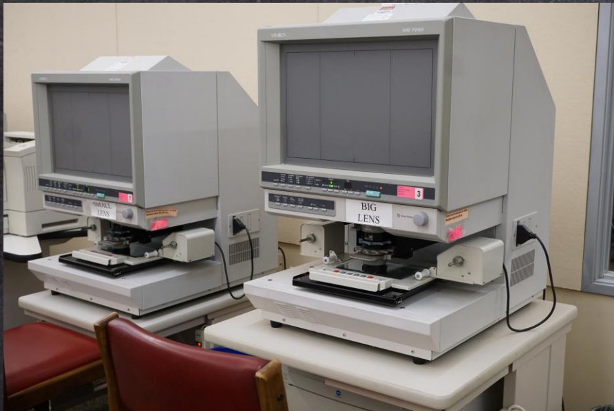
Gambar 5.6 Mesin untuk menulis mikrofilm dan pembaca mikrofilm
