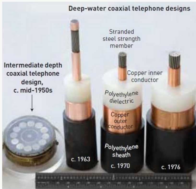
Gambar 11.9 Bentuk kabel Koaksial Bawah Laut
