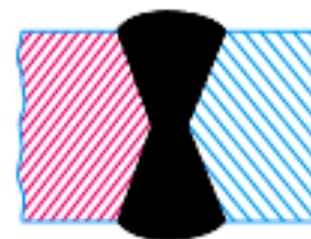
(d) Double V-butt joint.
