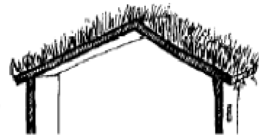
Atap pelana bertanaman tanpa ruang atap dan celah berventilasi
