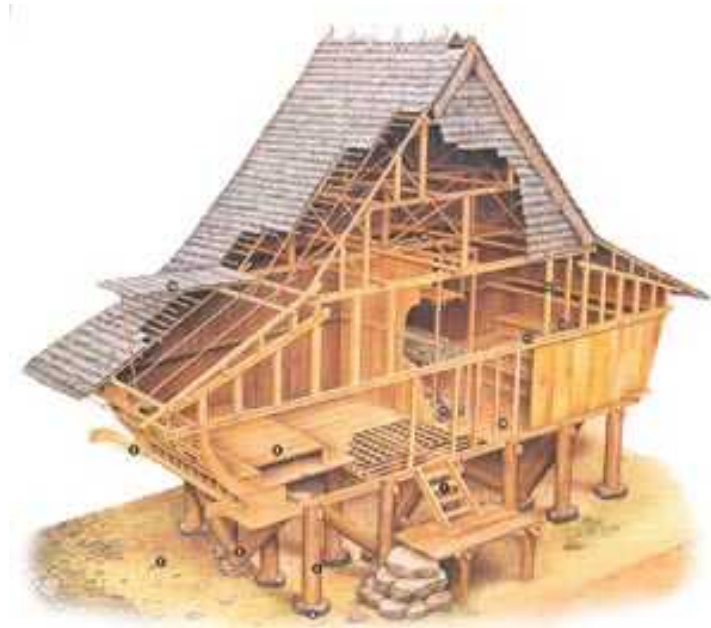
Gambar 2. .Perspektif potongan rumah tradisional Nias Bagian Selatan
