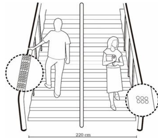
Gambar 2.46. Tangga yang dilengkapi dengan huruf braille di sisi atas pegangan rambatan pada interval tertentu yang menunjukkan posisi anak tangga
