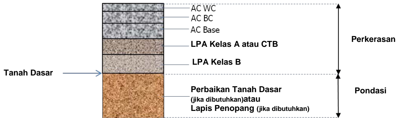
Struktur Perkerasan Lentur (Lalu Lintas Berat) pada Permukaan Tanah Asli (At Grade)
