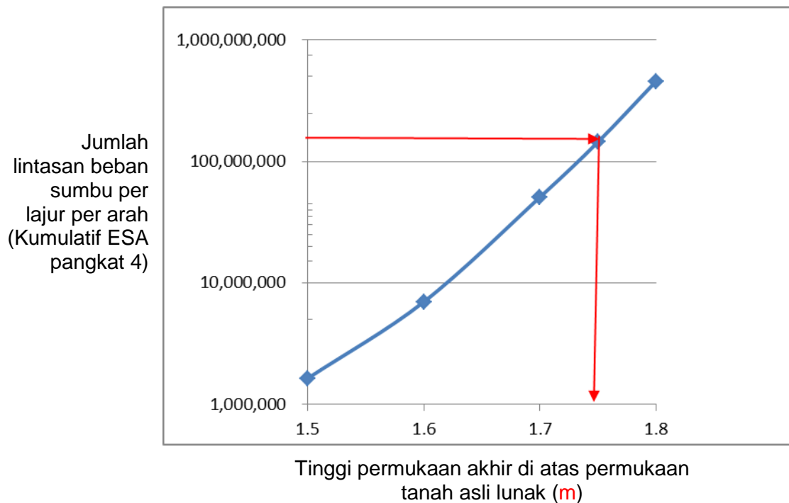
Gambar 10.3 Tinggi minimum dari permukaan akhir sampai batas deformasi plastis permukaan tanah lunak asli dibawah sambungan pelat
