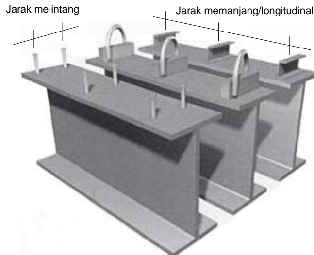
Gambar 10.4 : Susunan penghubung geser.
