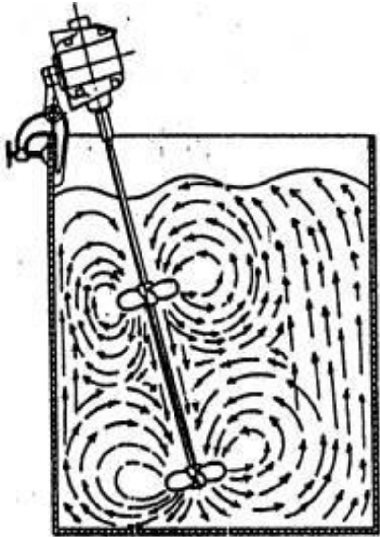
Mixer dengan dua propeller
