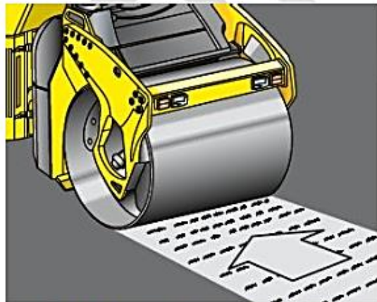
d. Retak melintang di belakang mesin pemadat
