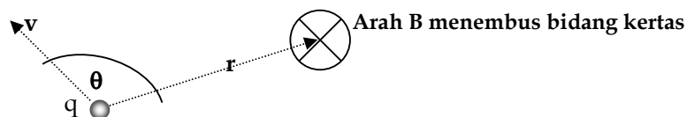
Gb. 6.7 Arah medan magnet yang dihasilkan dari sebuah muatan listrik yang bergerak
